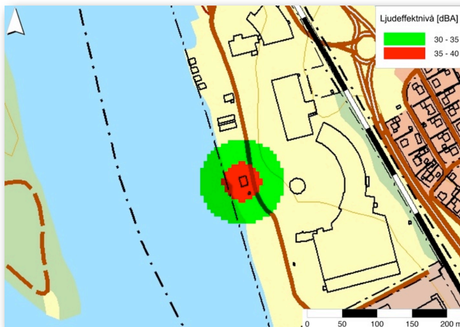
Figur 20. Ljudberäkning genomförd på Aeolos 10 kW på navhöjd 23 meter, beräkningarna genomförda i WindPRO. © Lantmäteriet Gävle 2010. Medgivande I 2010/0057.
